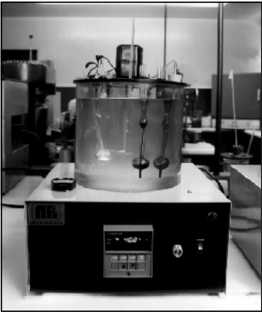
Figura 10.2 - Aparato utilizado para determinar la viscosidad cinemática.
