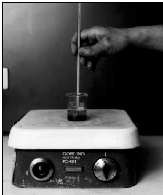
Figura 10.12 - Determinación del punto de anilina.
