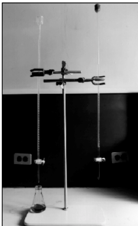
Figura 10.8 - Procedimiento para determinar el contenido de ácido en el aceite.
